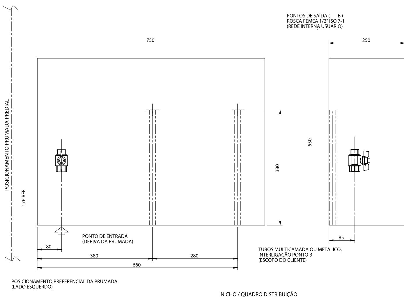
**Figura 52:** Instalação típica de conjunto CRM / CM G4 (1x2) - prumada 2 medidores
