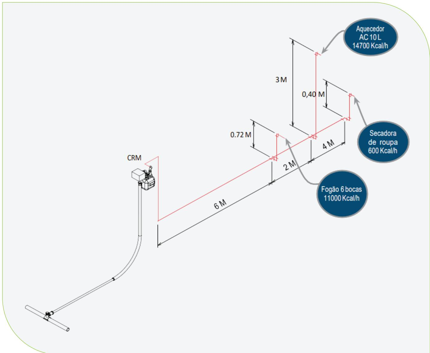
**FIGURA 26:** Desenho isométrico instalação residencial (TIP 7)
