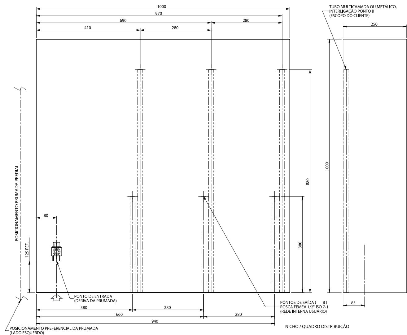
**Figura 59:** Instalação típica de conjunto CRM / CM G4 (3x2) - prumada 6 medidores
