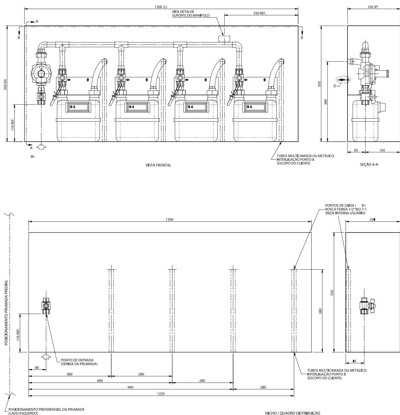
**Figura 54:** Instalação típica de conjunto CRM / CM G4 (1x4) - prumada 4 medidores
