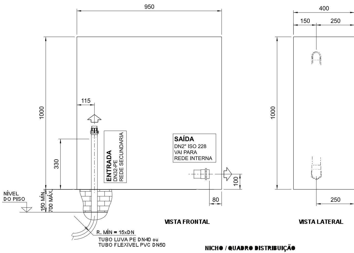
**FIGURA 50:** Instalação típica de conjunto CRM G65 - ramal PE
