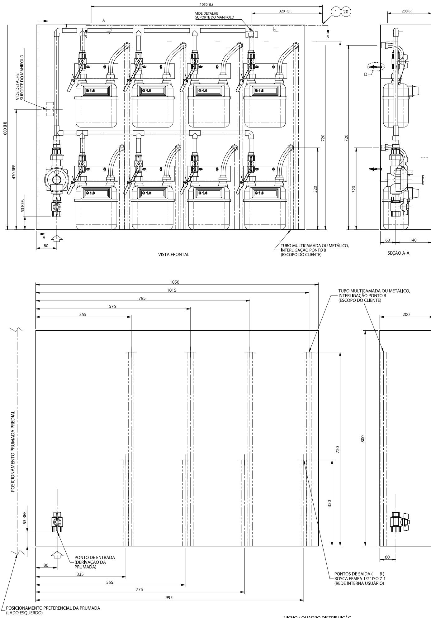
**Figura 60:** Instalação típica de conjunto CRM / CM G1.6 (2x4) - prumada 8 medidores
