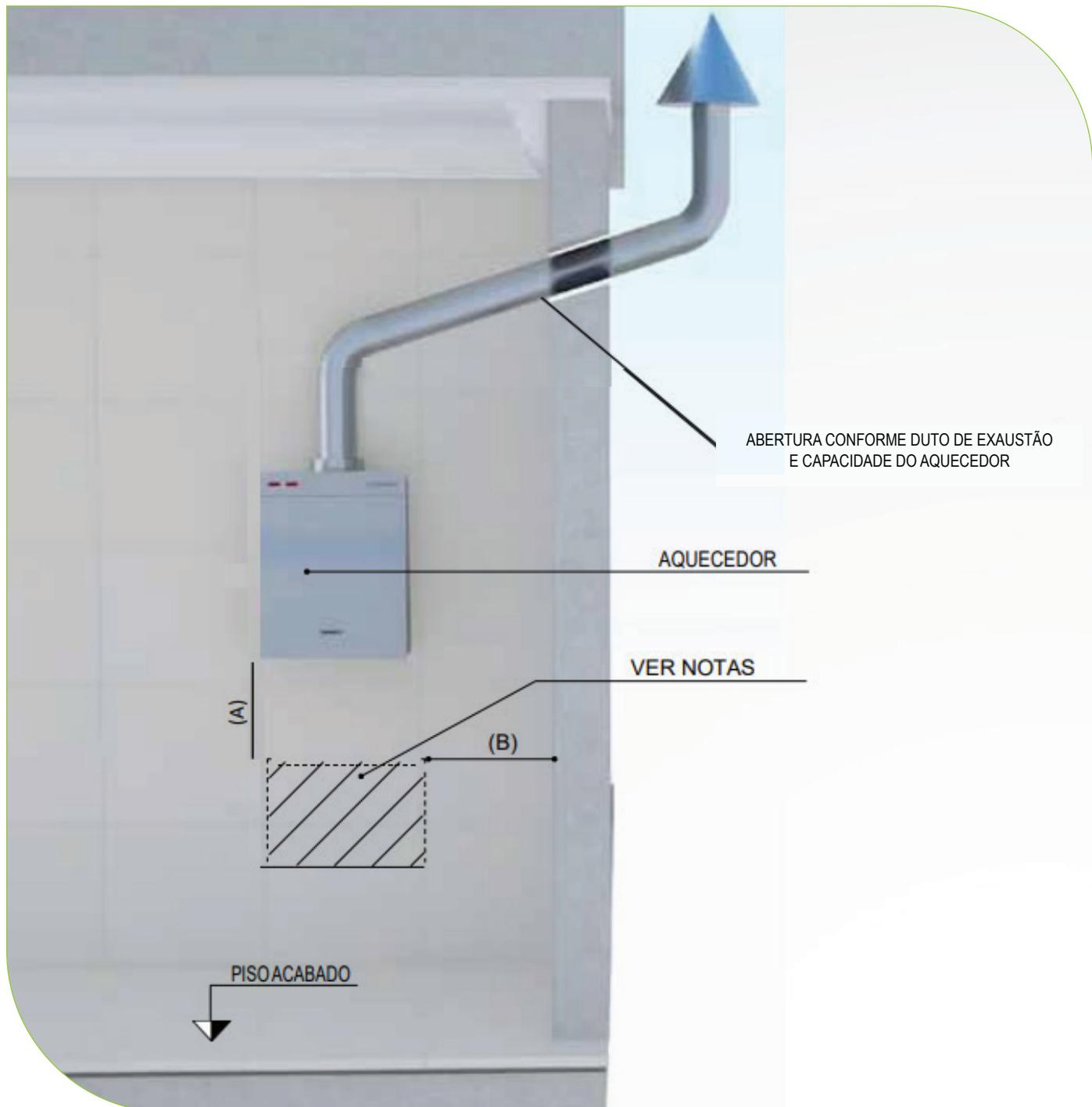
**FIGURA 15:** Posicionamento do aquecedor de passagem
