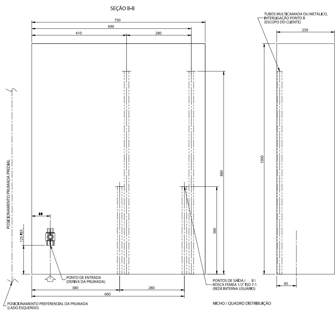
**Figura 55:** Instalação típica de conjunto CRM / CM G4 (2x2) - prumada 4 medidores
