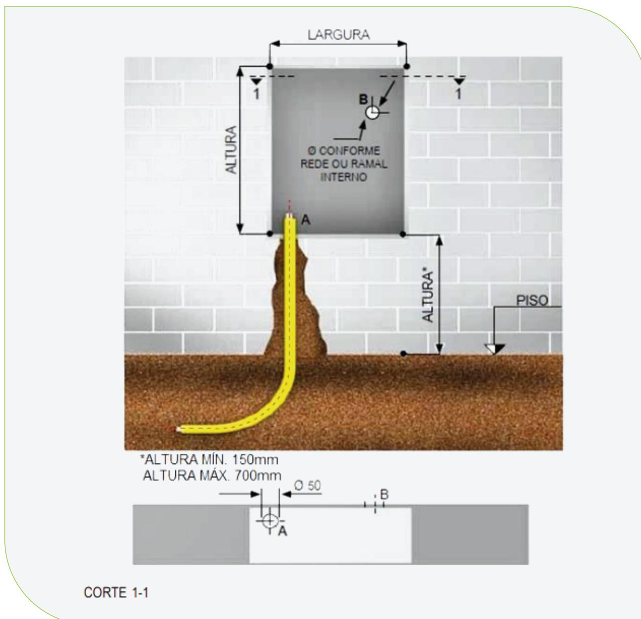
FIGURA 40: Ramal PE (detalhe típico)
