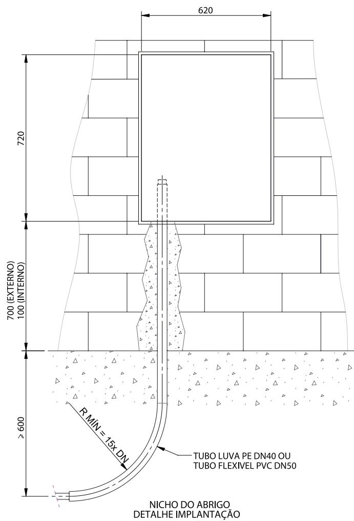
**FIGURA 48:** Instalação típica de conjunto CRM G16 - ramal PE
