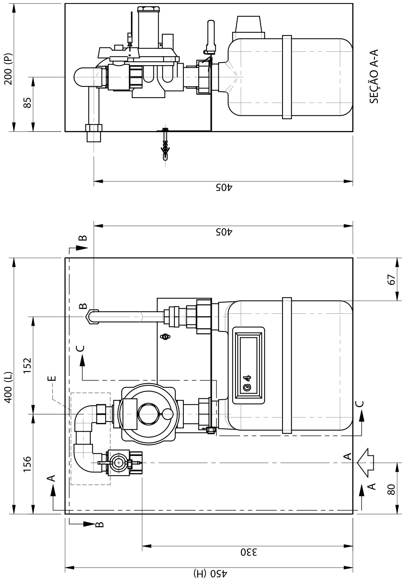
**FIGURA 51:** Instalação típica de conjunto CRM / CM G4 (lx) - prumada 1 medidor
