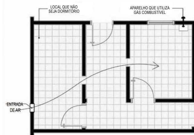
**FIGURA 9:** Ventilação inferior indireta - por meio de outros ambientes
