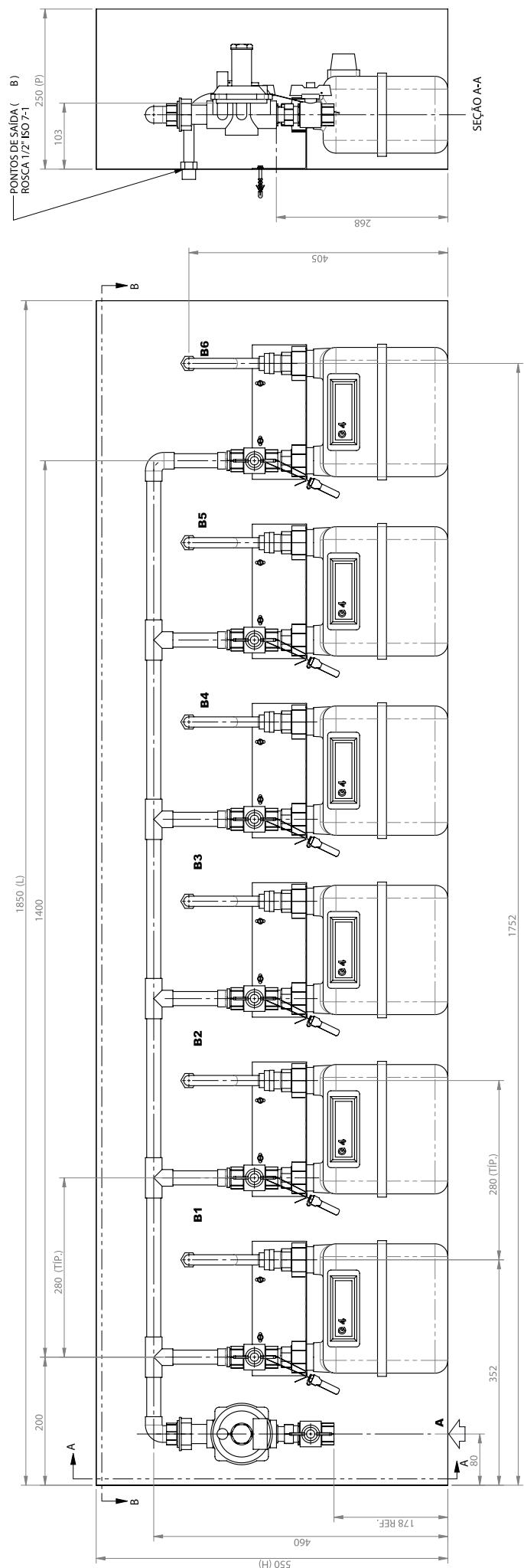
**Figura 57:** Instalação típica de conjunto CRM / CM G4 (1x6) - prumada 6 medidores
