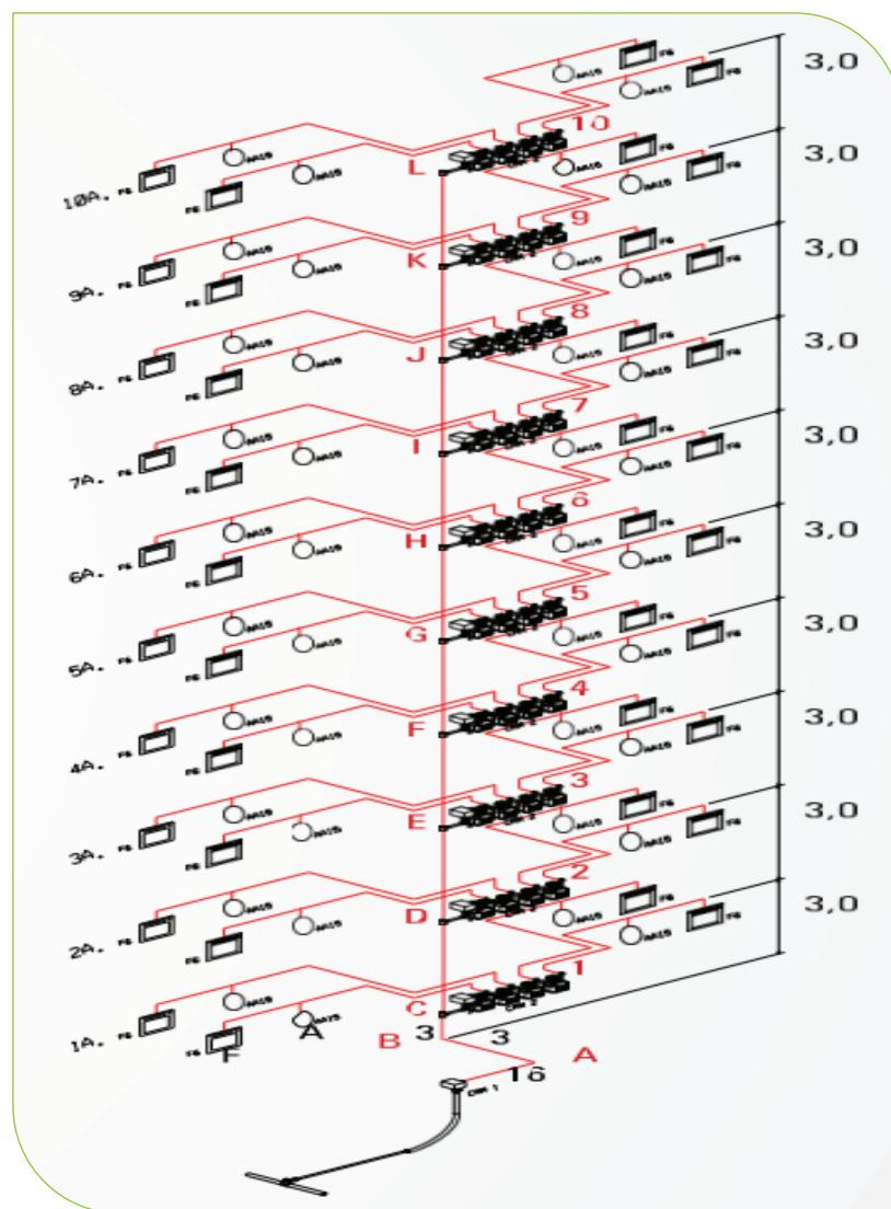
**FIGURA 27:** Desenho isométrico de instalação predial com estágio duplo de redução de pressão (TIP 4)
