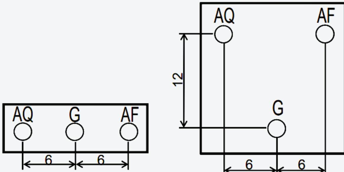
**FIGURA 16:** Sugestão de posicionamento do ponto de utilização para aquecedor de passagem. Consulte o manual do fabricante.
