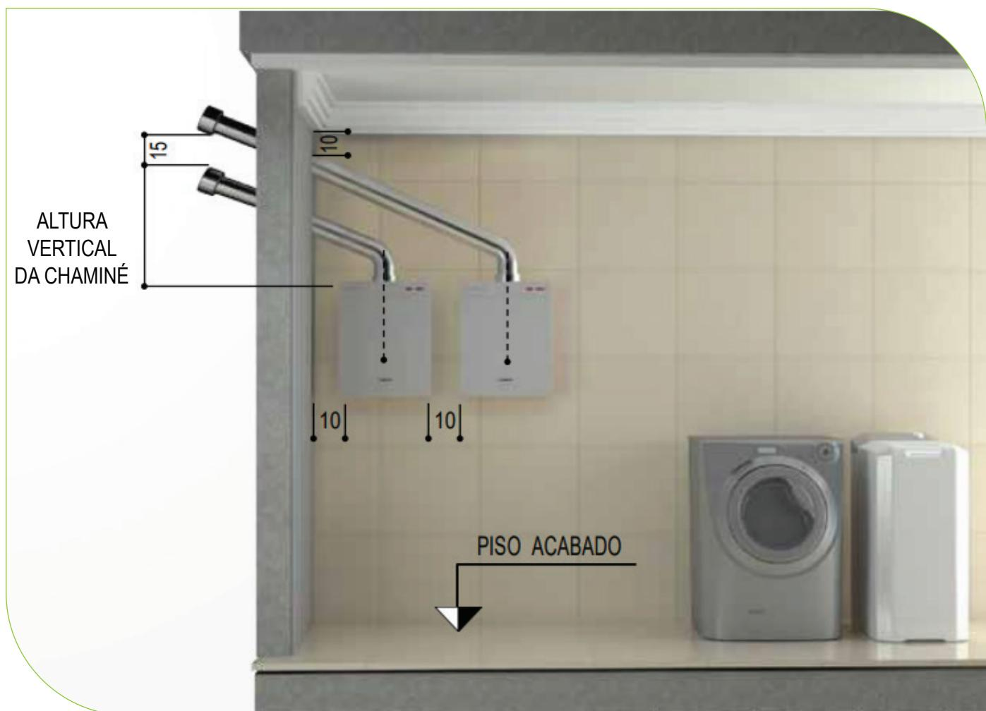
**FIGURA 11:** Instalação de dois aparelhos a gás com exaustão para chaminés individuais
